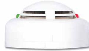
TGDR-1224M Mavigard Konvansiyonel Doğalgaz (Metan) Gaz Dedektörü Tavan Tipi, Röle Çıkışlı 12/24V DC
